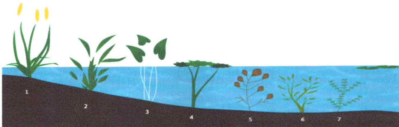
FIGURA 1. Fitosistema para la remediación de las aguas residuales de las localidades del municipio de Actopan Veracruz. Este sistema consiste en la depuración de las aguas de descarga municipales locales,
