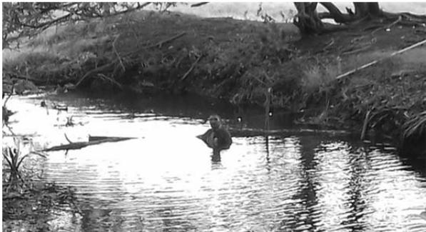
**Aforo No. 1.-** Se realizó de 9:00 am a 10:57 am, el ancho del cauce es de 6.88 metros y utilizando la fórmula de sección de  $(Y1+2Y2+Y3)/4=$  profundidad promedio, se tiene el siguiente valor para el primer aforo:
